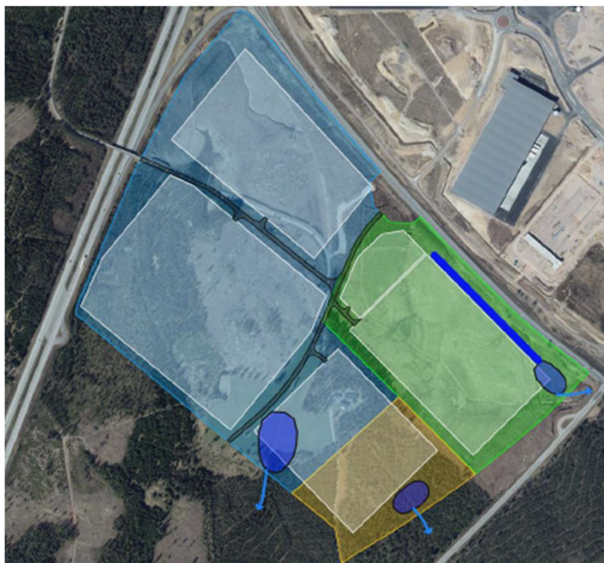
Kartan ovan visar ungefärligt ytbehov av föreslagna dagvattenanläggningar och föreslagen placering samt utloppsriktning för respektive avrinningsområde. Mörkblå ovaler = dagvattendammar; mörkblått streck = svackdike; ljusblå pilar = riktning för utlopp. Karta från den till detaljplanen tillhörande dagvatten och skyfallsutredningen (Sweco 2025)
