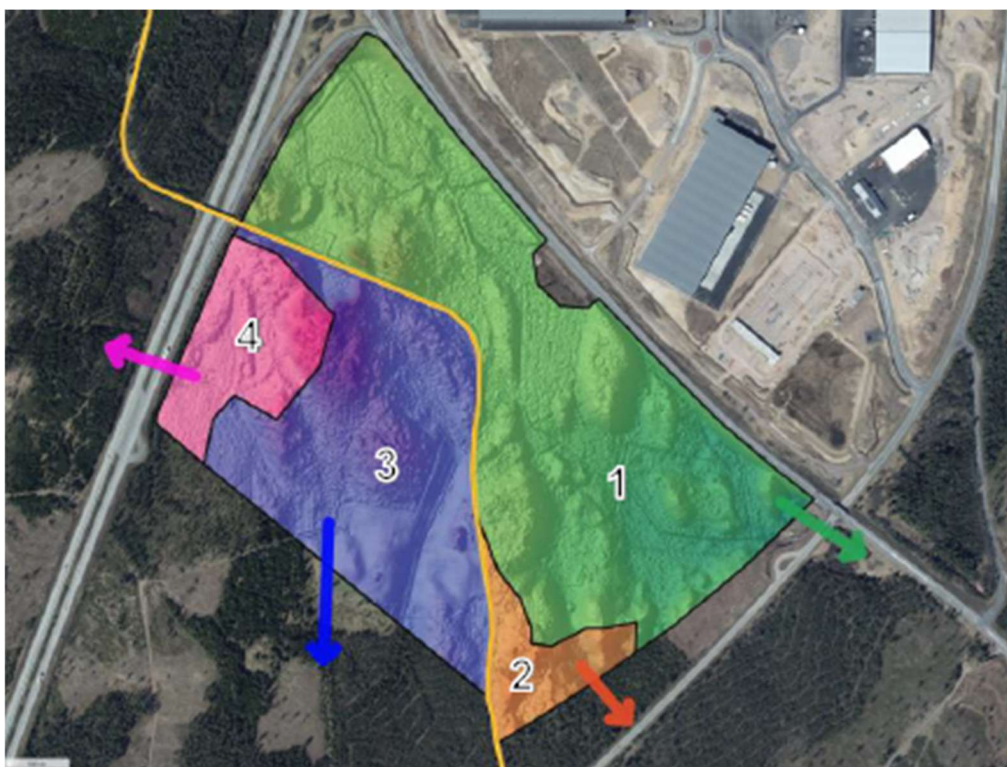
Indelning av planområdets avrinningsområden med redovisad utflödesriktning. Siffrorna hänvisar till respektive avrinningsområde. Orange streckning är enskild väg. Karta från den till detaljplanen tillhörande dagvatten och skyfallsutredningen (Sweco 2025)
