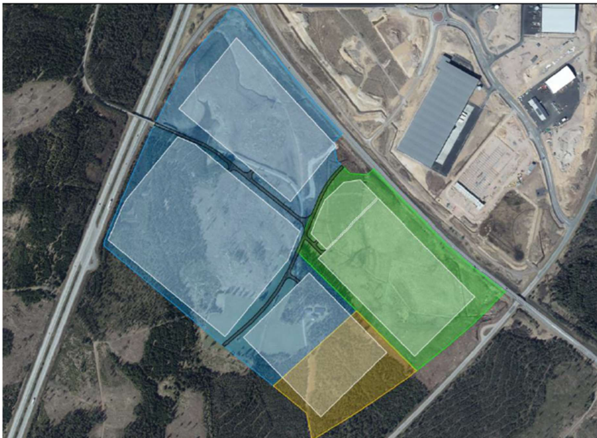
Planområdets framtida avrinningsområden och planerade hårdgjorda ytor. Grön = avrinningsområde A ; gul = avrinningsområde B; blå = avrinningsområde C; vit = hårdgjorda ytor; svart = vägar. Karta från den till detaljplanen tillhörande dagvatten och skyfallsutredningen (Sweco 2025)
