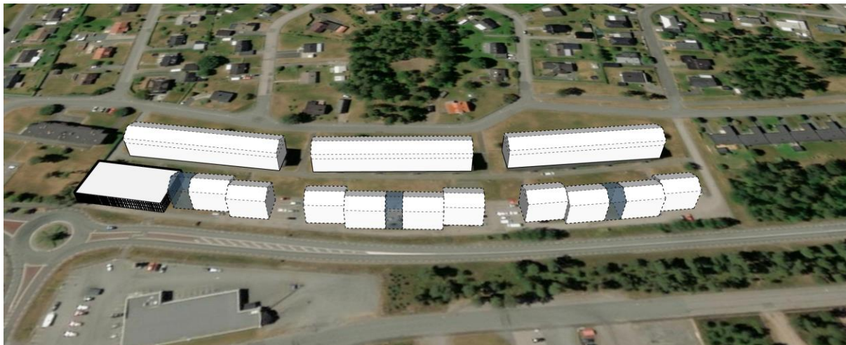
Figur 4: Illustration av möjliga bebyggelsevolym (byggrätter). Bilden visar ett exempel på hur den högsta tillåta bruttoarean för huvudbyggnader kan utformas. Högsta tillåta byggnadsvolym för huvudbyggnader illustreras genom heldragna vita, streckade vita samt blåstreckade volymer tillsammans. Komplementbyggnader såsom exempelvis miljöhus och förråd illustreras inte utan tillkommer. Bebyggelsevolymerna kan utformas på annat vis än denna illustration.
