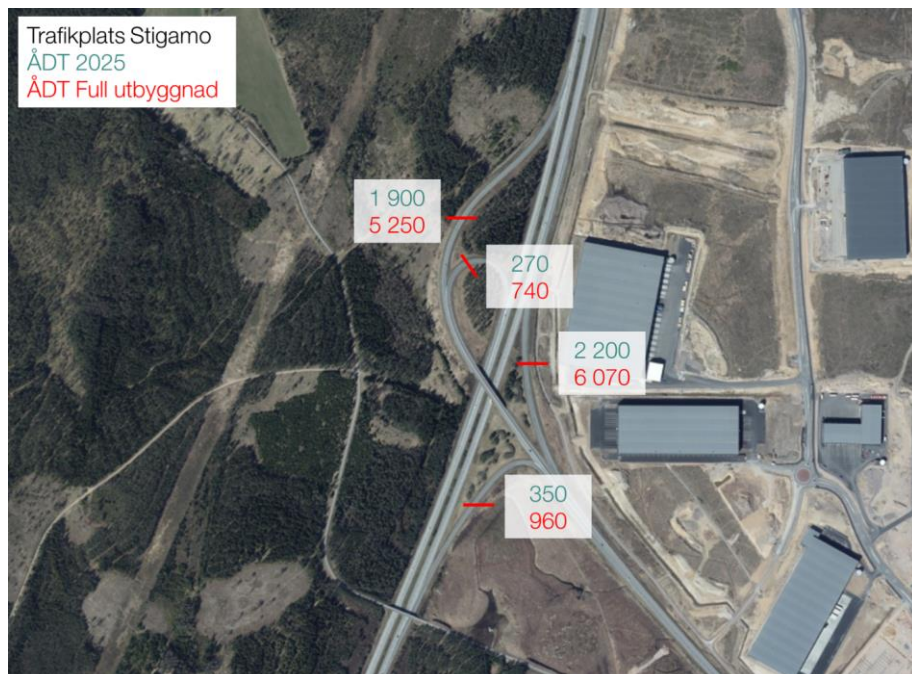
Figur 41 Total trafik på ramperna i trafikplats Stigamo vid full utbyggnad, efter 2040, uppskattas till 13 000 fordon/dygn. Detta motsvarar en ökning på 175 % jämfört med idag.
