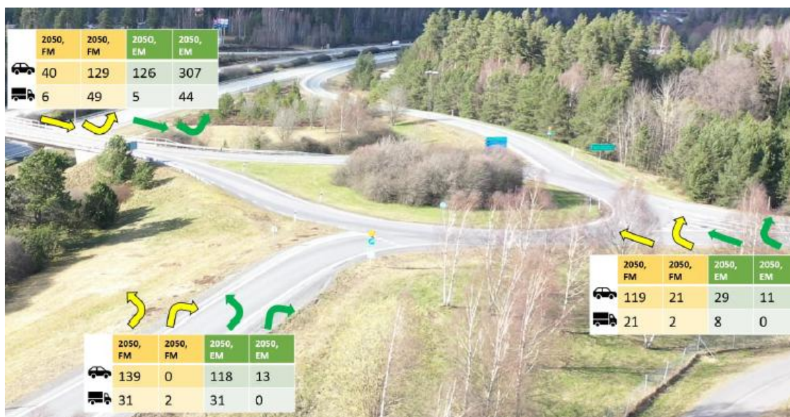
Flöden korsning C: väg 152/ramper östra sidan E4/F 806, år 2050 med exploatering (f/h). Bild ifrån Trafikutredning, WSP.
