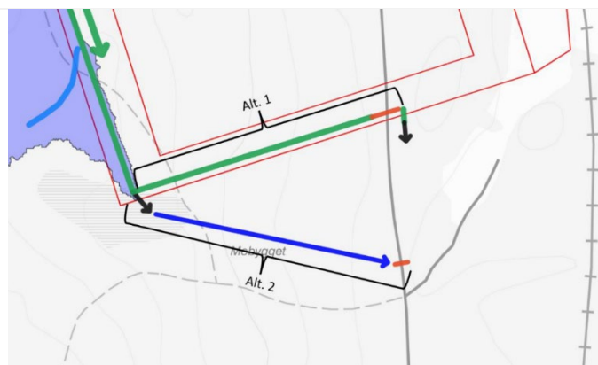
Alternativ för hantering av naturmarksflöden som leds söderut. Grön linje illustrerar dikessträcka, gröna pilar flödesriktning och svarta pilar där vatten släpps i naturmark, röda linjer förslag på placering av trummor och blå linjer naturliga befintliga dikessträckor. Mörkblå pil illustrerar var vatten kommer rinna genom naturmark mot lågpunkt intill väg. Bild ifrån Dagvattenutredning, Sweco.
