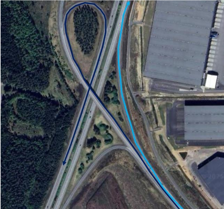
Figur 15. Placering och utformning för befintlig trafikplats Stigamo. Påfartsramper norrut (ljusblå linje) och påfartsramper söderut (mörkblå linje).
