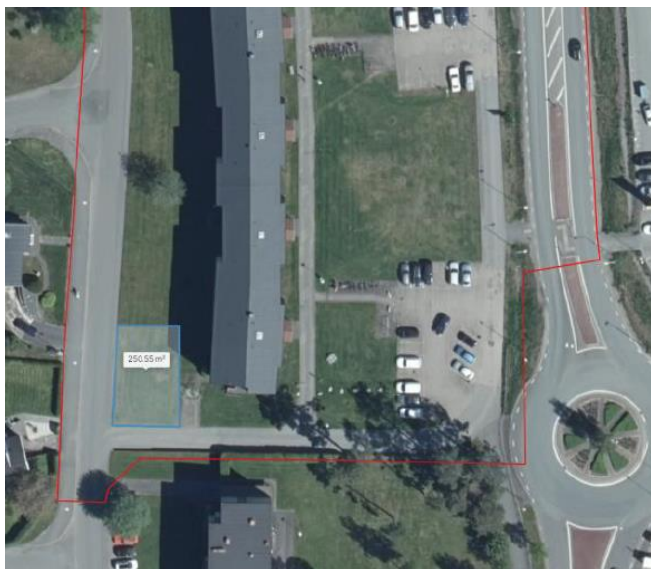
Figur 8: Förslag på placering och utbredning för nedsänkt gräsyta, vilken har funktion för fördröjning och rening av dagvatten.
