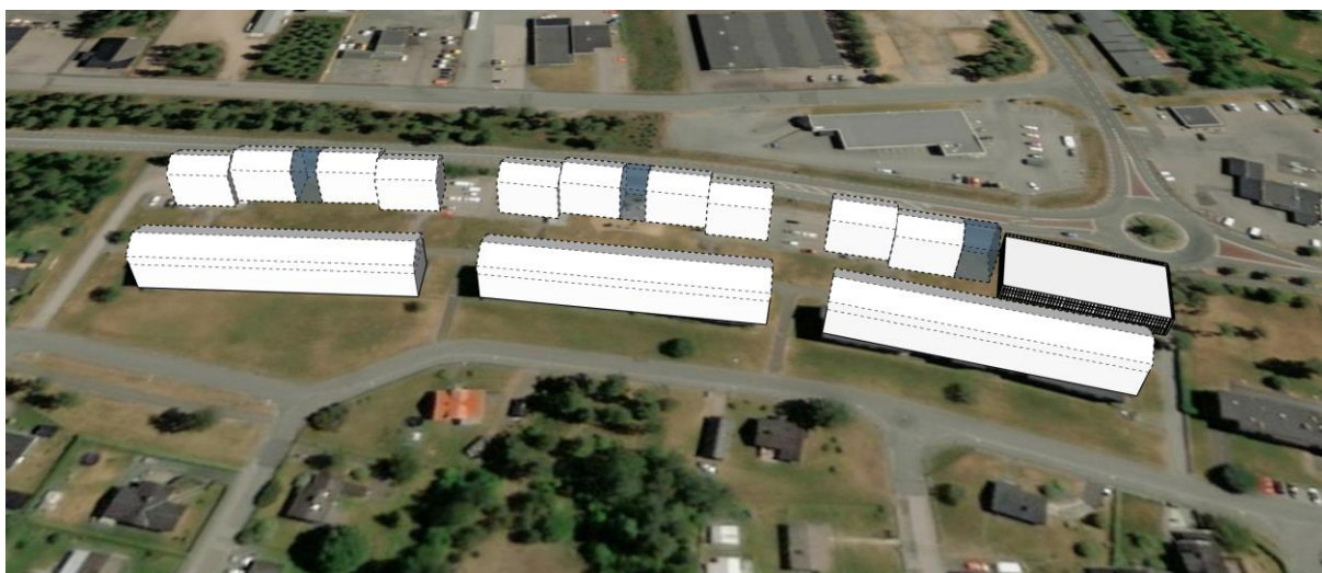
Figur 5: Illustration av möjliga bebyggelsevolym (byggrätter). Bilden visar ett exempel på hur den högsta tillåta bruttoarean för huvudbyggnader kan utformas. Högsta tillåtna byggnadsvolym för huvudbyggnader illustreras genom heldragna vita, streckade vita samt blåstreckade volymer tillsammans. Komplementbyggnader såsom exempelvis miljöhus och förråd illustreras inte utan tillkommer. Bebyggelsevolymerna kan utformas på annat vis än denna illustration.
