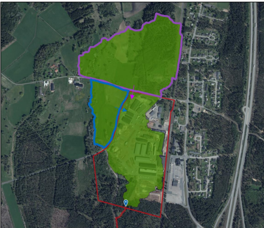
Figur 5. Grönt område redovisar det totala tillrinningsområdet uppdelat, där punkter för inkommande vatten är redovisade med pilar. Blå markör visar utströmningspunkten.
