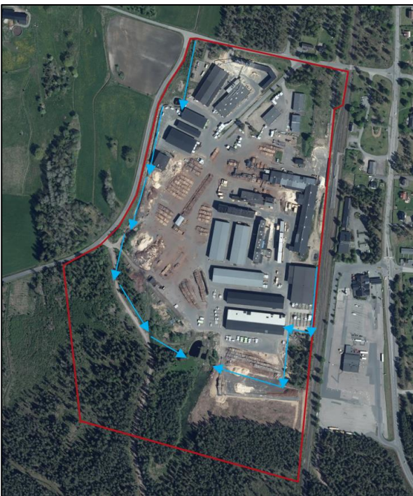
Figur 9. Föreslagen dragning av diken längs planområdets gränser för att säkerställa avledning av dagvatten.
