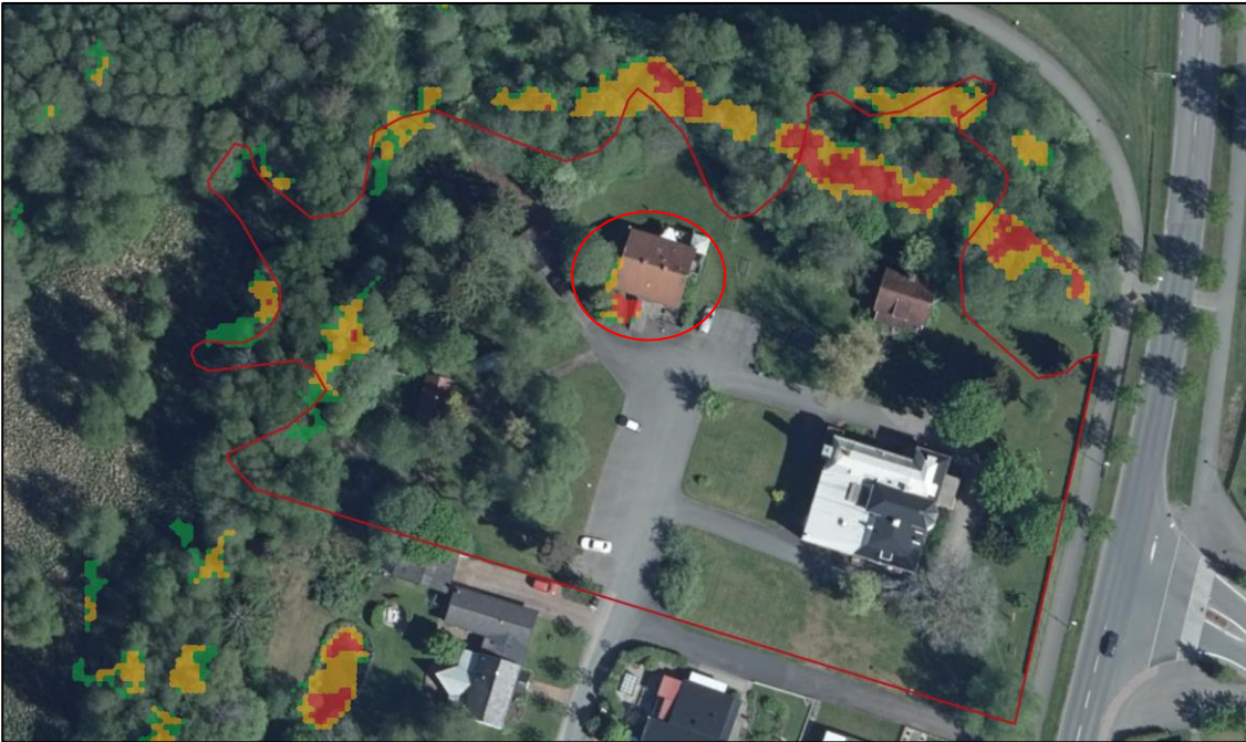
Figur 10. Djup på vattnet i översvämningpunkterna. Grön 0–10 cm. Gul 10–30 cm. Röd 30+ cm. Inom planområdets bebyggda delar magasineras en begränsad mängd vatten vid extremregn. Större översvämningvolymerna sker i angränsande vattendrag. (Scalco, 2022). Aktuell byggnad med risk för stående vatten är markerat med röd cirkel.
