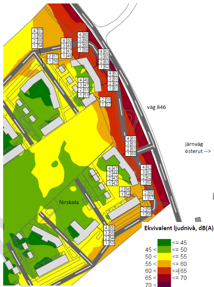
Figur 9: Ekvivalent dBA-nivå vid fasad.
