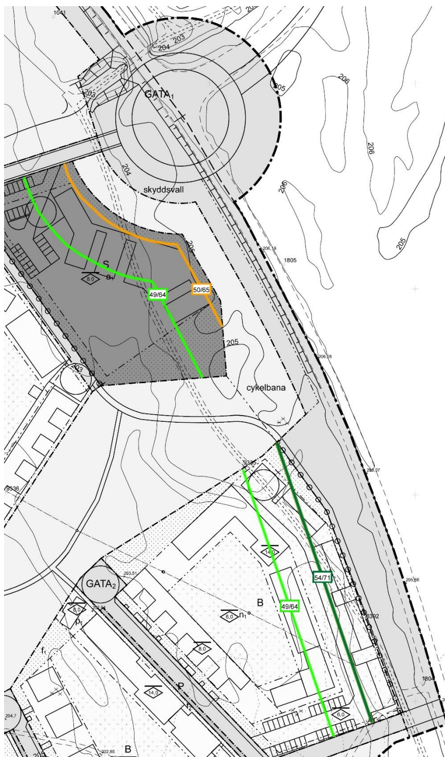
Trafikbullerkartering 2021, gröna markeringar visar på frifältsvärden för ekvivalent/maximal ljudnivå 50, respektive 30 meter från vägen.
