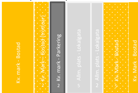
Illustrerat tvärsnitt av lokalgata typ A. 5 meter tvåfilig körbana med 2 meter trottoar på allmän plats.
