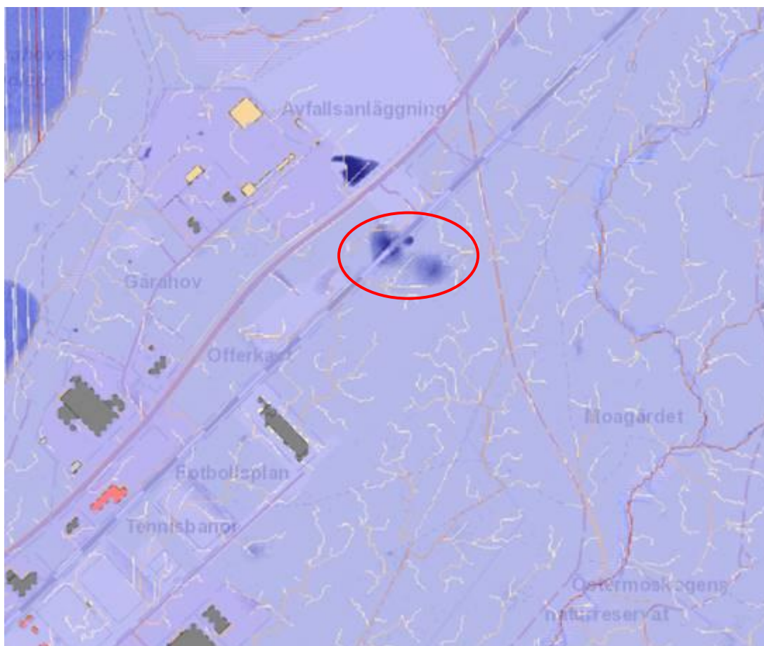
Figur 7: Skyfallskartering med ytavrinning (gula/orange linjer) och instängda områden (mörkblå områden). I kartan är lågpunkten intill järnvägen inringad med röd markering.
