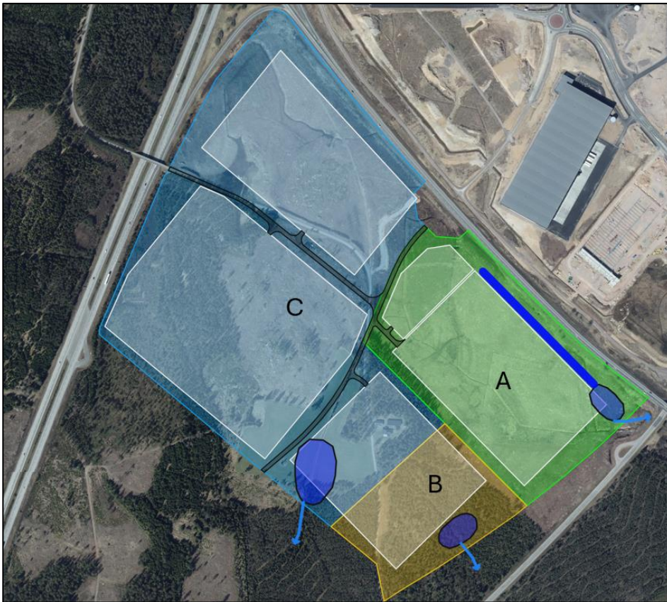
Figur 11. Ungefärligt ytbehov av föreslagna dagvattenanläggningar och föreslagen placering samt utloppsriktning för respektive avrinningsområde. Mörkblå ovaler = dagvattendammar; mörkblå streck = svackdike; ljusblå pilar = riktning för utlopp.
