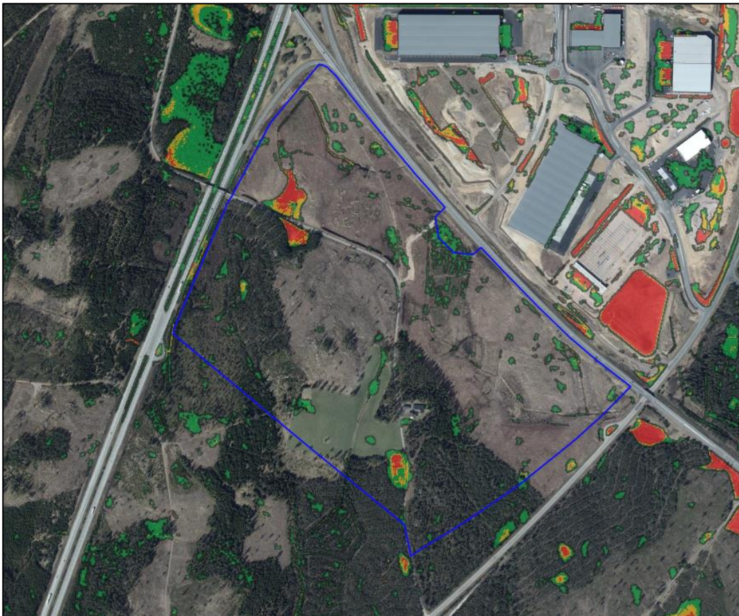
Figur 13. Översvämningssytor med redovisat vattendjup och ytliga avrinningsvägar inom planområdet. Färgskalan redovisar vattendjup. Grön: 0 – 30 cm. Gul: 30 – 50 cm. Röd: >30 – 50 cm. Med utgångspunkt i Klimatologi 47 motsvarar ett 100-årsregn med 1 timmes varaktighet och klimatfaktor 1,4, 63 mm regnbelastning (SMHI, 2017). Modellen i Scalgo Live har således belastats med 63 mm nederbörd. Med hänsyn till infiltration så fylls lågpunkterna inom planområdet för befintlig situation med 1 400 m 3 , vilket inte utgör lågpunkternas fulla kapacitet.
