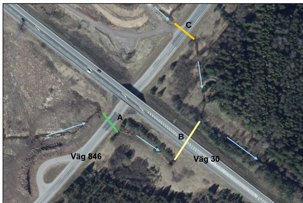
Figur 1. Placering av aktuell trumma A (grön), ytterligare trummor under väg 30 B (gul) och väg 846 C (orange), samt flödesriktning i diken (blå pilar).
