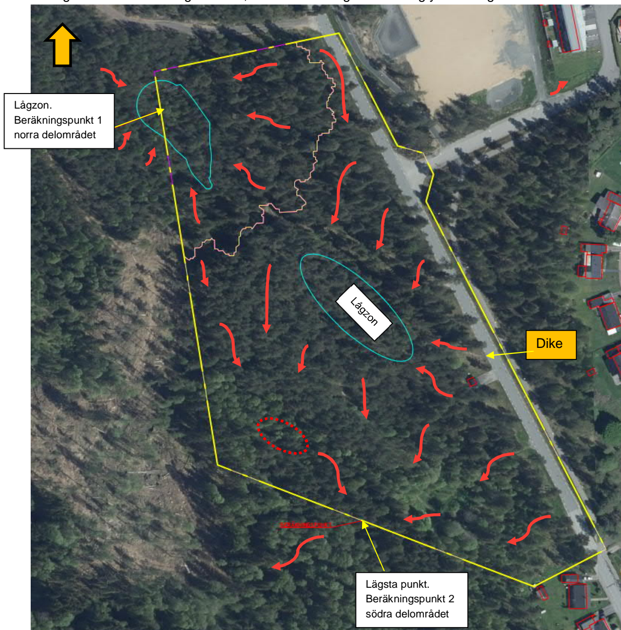
Figur 2. Markanvändning, gräns för avrinningsområde (rosa linje) och befintlig ytavrinning (röda pilar). Blå ellips/figur anger större lågzon. Röd ellips anger mindre lågpunkt. Bildkälla: Scalgo live.
