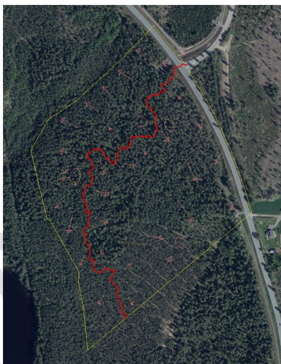
Figur 8: Befintlig dagvattenavrinning inom planområdet. Delningsrygg enligt röd linje.
