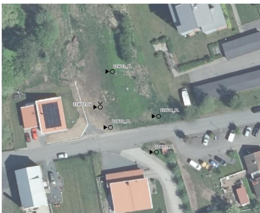
Figur 2. Placering av provpunkter för porluft. Grundvattenrör 21W02-GV syns även i bilden.
