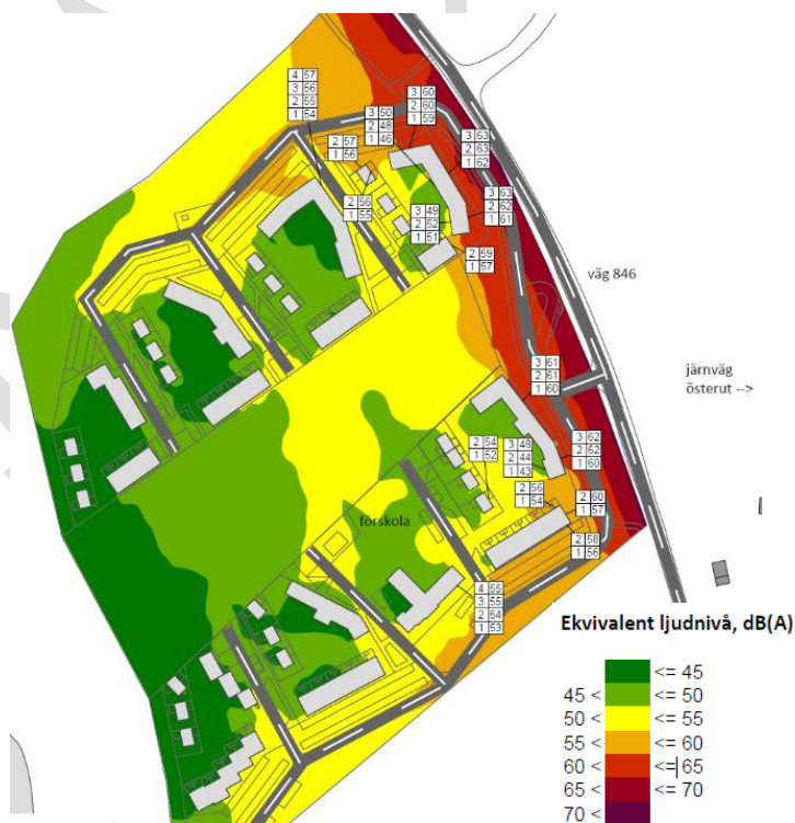
Figur 18: Ekvivalent dBA-nivå vid fasad.
