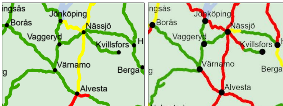
Figur 6. Kapacitetsutnyttjande år 2024 av järnvägsnätet i anslutning till utredningsområdet. Bild till vänster avser ett vardagsdygn och bilden till höger avser den mest belastade tvåtimmarsperioden under dygnet. Röd = högt kapacitetsutnyttjande, gul = medel kapacitetsutnyttjande, grön = lågt kapacitetsutnyttjande (Trafikverket, 2025a).
